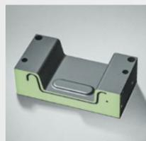
Per Laserauftragschweißen erzeugte, innen liegende Kanäle kühlen das Werkzeug genau dort, wo es sinnvoll ist.
