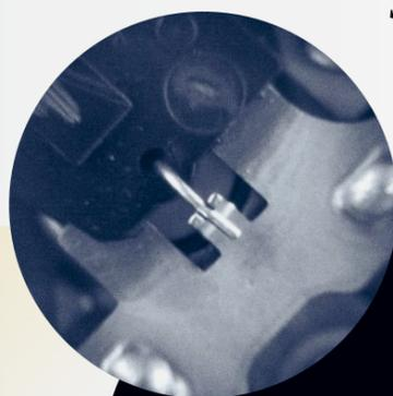
Kamerabild der Bauteilsituation: Draht in Gabel (links). Der OCT-Sensor richtet sich selbst ein und erkennt aus der Draufsicht die Höhenunterschiede.
