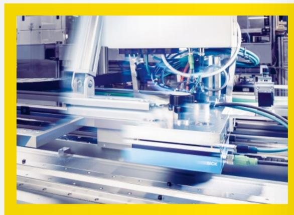
vorbeirauschenden Teils – sei es aus Metall, Kunststoff oder sonst etwas. Ein optischer Resonator fängt die Reflexion des Laserstrahls auf und mischt sie mit dem Licht im Resonator. Eine Photodiode misst die Interferenz und das System errechnet aus dem Frequenzunterschied die Bewegungsgeschwindigkeit. Aus der Modulation der Wellenlänge lässt sich die Richtung
