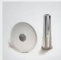
Kern für Spritzguss aus H11-Stahl: rissfrei, Dichte 99,9 Prozent, sehr gute Polierbarkeit. Mit integrierten Kühlkanälen ist die Kühlperformance vergleichbar zu Kupferkernen, aber bei viel höherer Standzeit.
