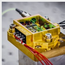
Der 50-Cent-große diodengepumpte Festkörperlaser hält extremen Bedingungen stand.
