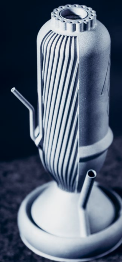
3D-gedruckter Thruster für die Lageregelung bei der Mondlandung.
