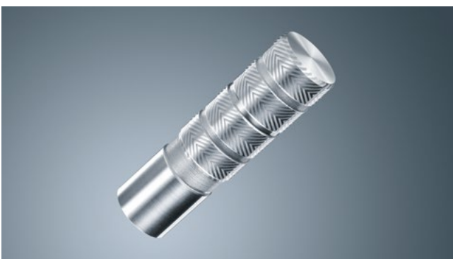
Strukturierender Auftrag ohne Schmelzauswurf.
