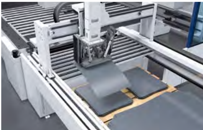
Der Sauggreifer belädt die TruBend Center 7030 automatisch mit großen oder kleinen Platinen, während die Maschine arbeitet.
