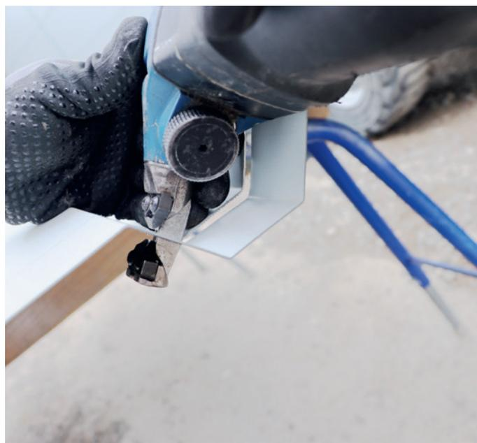
▲ Im Detail: Das kurze Werkzeug schafft Trapezbleche bis 85 mm Profiltiefe
